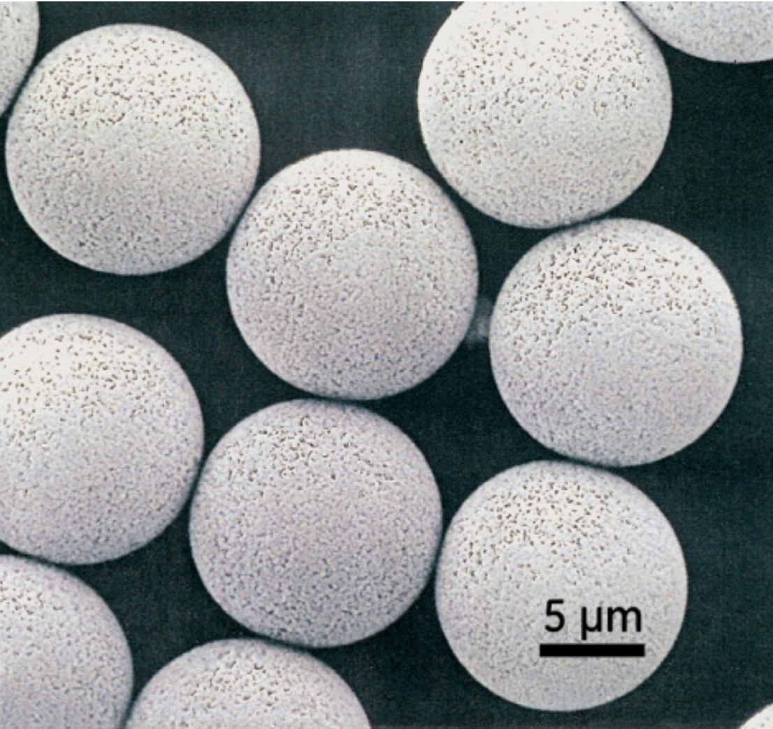
图 6.11. SOURCE™ 15RPC 颗粒的扫描电子显微照片显示了均匀的尺寸分布。
