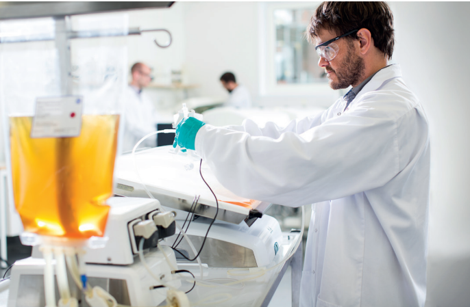
图 3. 配有 ReadyMate™ 快接头的 Cellbag™ 可快速且无菌的连接到下游的操作设备。
