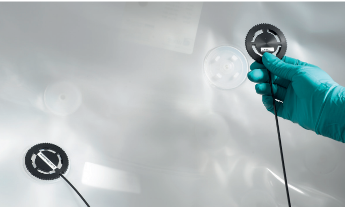
图 5. 光学传感器嵌入于 Cellbag™ 生物反应袋的底部。这里显示的是连接到袋端口的袋适配器/光纤电缆。
